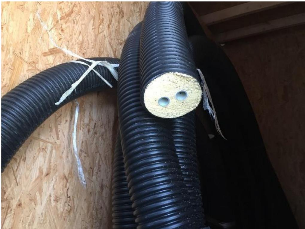
Figura 6: Il teleriscaldamento a bassa temperatura permette l'uso di tubature in plastica (si veda qui una tubatura binata), che hanno costi inferiori e risultano più semplici da montare, grazie alla loro flessibilità (Fonte: B. Doračić)
