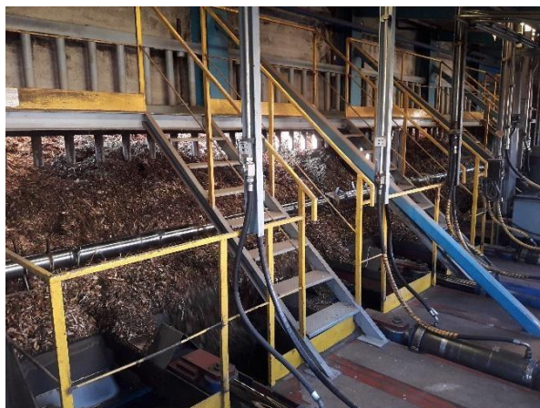
Figura 42: Centrale di cogenerazione di Salcininkai, in Lituania, dove la caldaia a biomassa (5 MW th ) ha sostituito una delle tre unità di cogenerazione a gas naturale. Le due unità rimanenti hanno una capacità di 3,5 MW th e 6 MW th (Fonti: D. Rutz)
