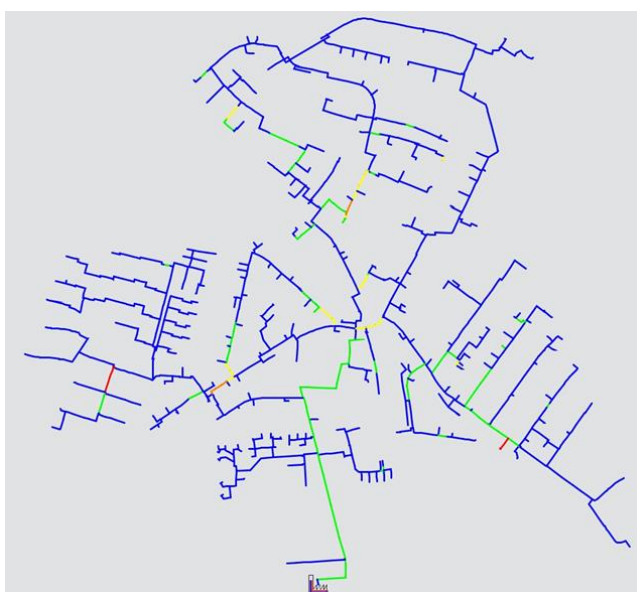
Figura 21: Esempio di modello di base TERMIS (Fonte: COWI)
