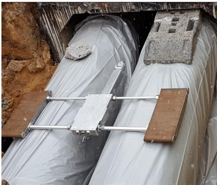
Slika 27 Vizualna inspekcija pomoću uređaja “Crawler Eye” razvijenog u „Institut für Angewandte Bauforschung Weimar gmbH“ (Izvor: AGFW)
