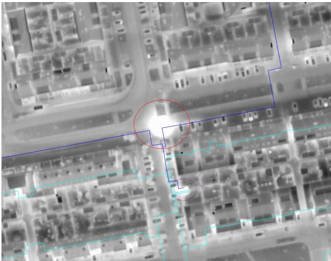
Rysunek 20: Obrazowanie termiczne sieci ciepłowniczej pokazujące duży wyciek na rurociągu (Źródło: COWI)
