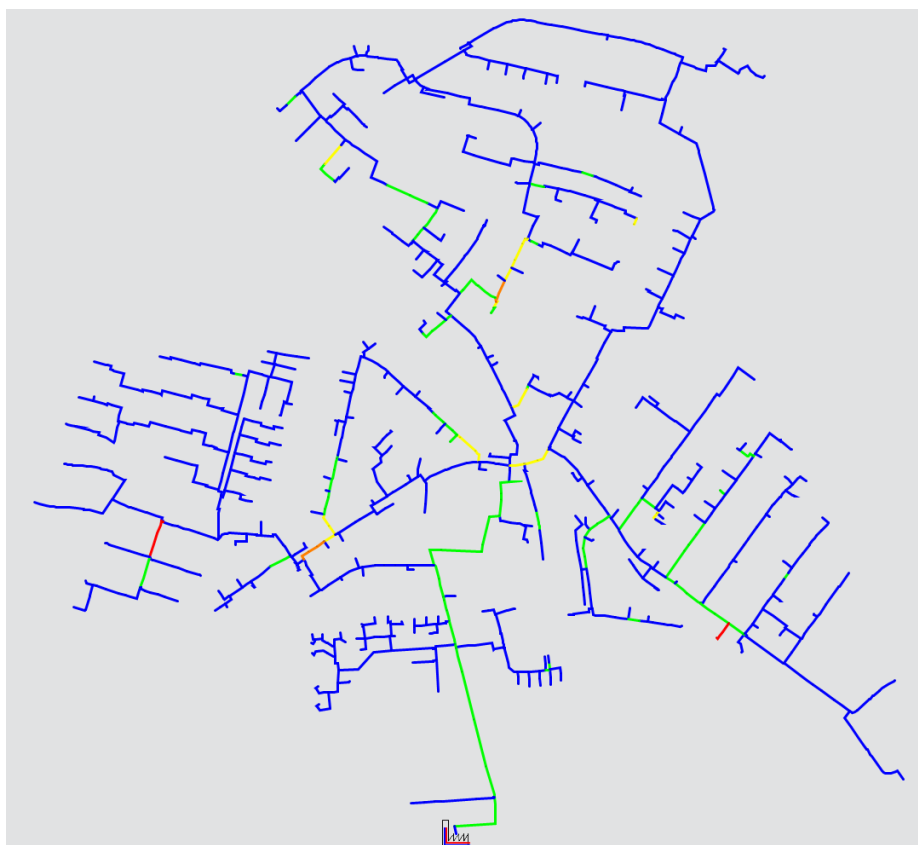
Rysunek 21: Przykład podstawowego modelu TERMIS (Źródło: COWI)
