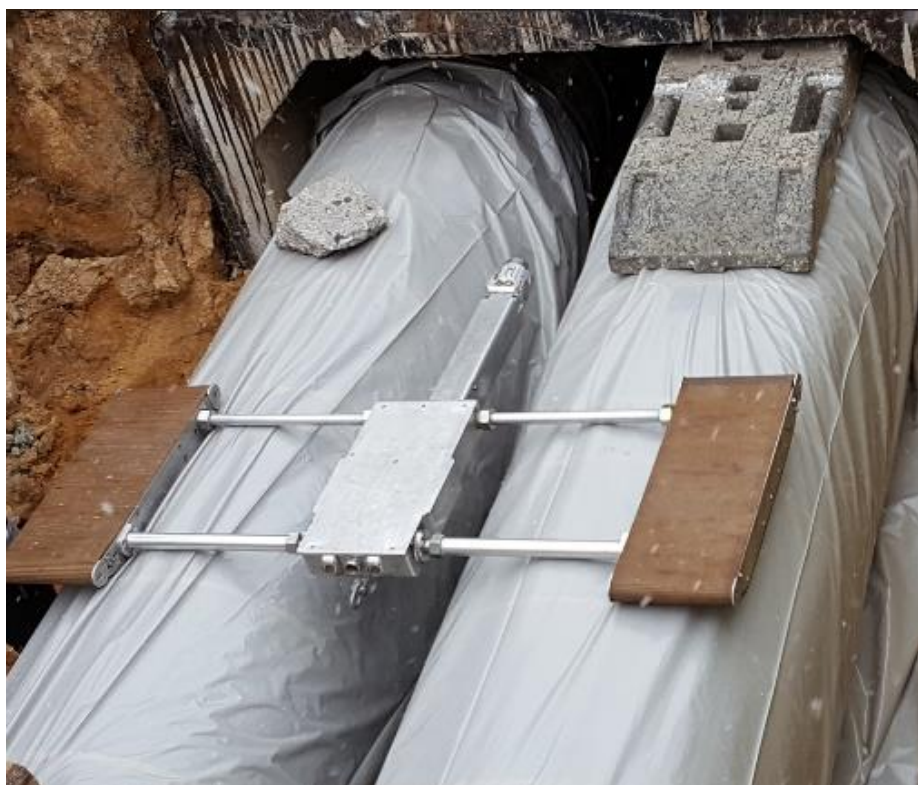
Rysunek 27 Wizualna kontrola „Crawler Eye” Niemieckiego Instytutu Angewandte Bauforschung Weimar gmbH (Źródło: AGFW)
