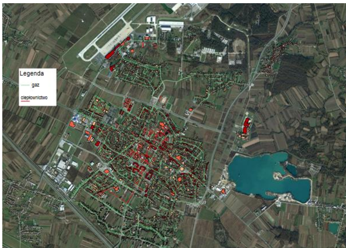
Rysunek 15: Gaz ziemny i sieć ciepłownicza w mieście Velika Gorica w Chorwacji (źródło: T. Novosel)
