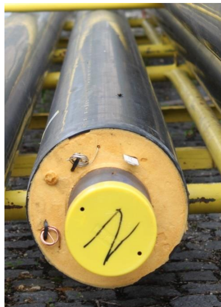
Rysunek 29: Rysunek przekroju rury z płaszczem z tworzywa sztucznego i jej połączenia (Źródło: AGFW, 1993) (po lewej) oraz zdjęcie tego typu rury w naturze (Źródło: D. Rutz) (po prawej)
